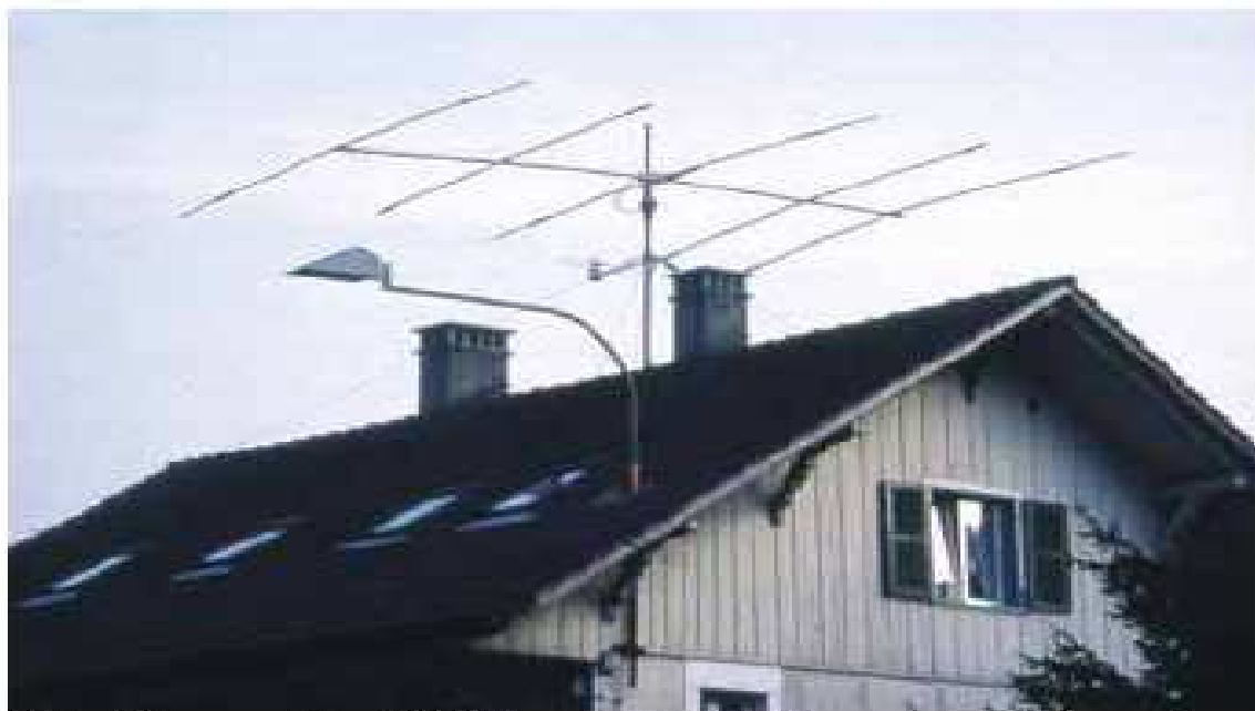
Auf Grund der grossen Typenvielfalt können Amateurfunkantennen sehr verschieden aussehen. Hier ist eine sogenannte Yagi-Dachantenne abgebildet.
